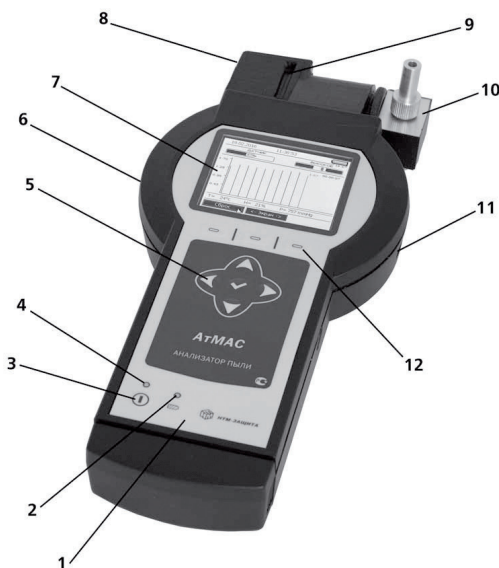
Рисунок 1. Внешний вид анализатора пыли «Атмас»
