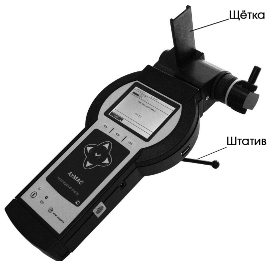
Рисунок 7. Очистка датчика от пыли.
