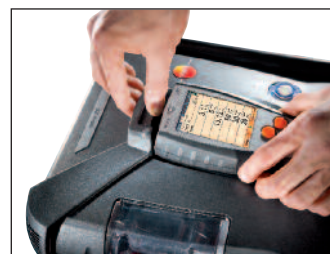
Управляющий модуль просто "защелкивается" в блок анализатора
