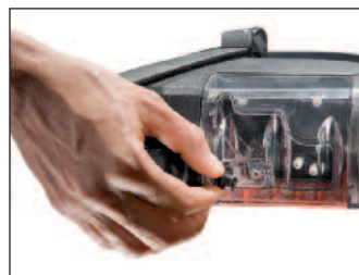
Режим непрерывной откачки конденсата для продолжительных измерений
