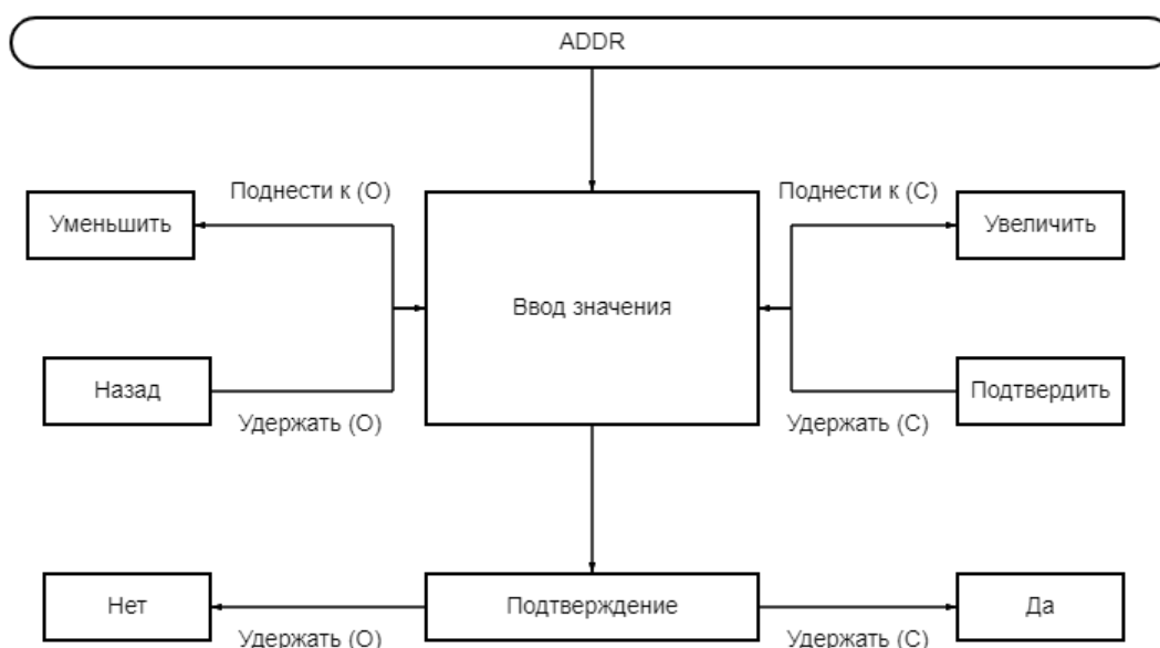
Рисунок К.2.9 – Алгоритм изменения адреса MODBUS
